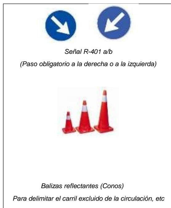
**Las señales P-18 y R-401 y resto de las señales requeridas, deben situarse a una distancia mínima de 50 metros de la zona de trabajo y ser visible desde 100 metros por los conductores que circulen en el sentido excluido de la circulación. Esta señalización será suficiente para las calzadas de sentido único o que tengan más de tres carriles. En otro caso, deberá repetirse la misma señalización en el sentido contrario.**
